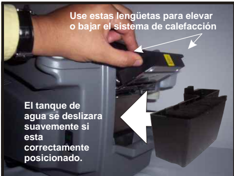
FIGURA 9. Manejo del sistema de calefacción
